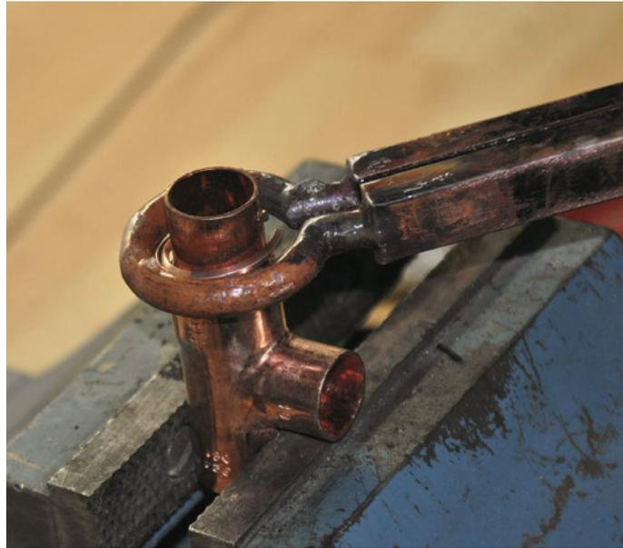
◀ Bild 3. Einer der frühen Versuche mit einem Ringinduktor und selbstgebogenem Lotring – die Effizienz passte noch nicht.
