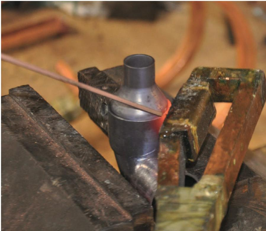
▲ Bild 1. Mit dem normalen Lotstab und einem Standardinduktor scheiterten die Versuche: zu ungleichmäßige Erhitzung des Werkstücks, das Lot bekommt keine Induktion ab.
