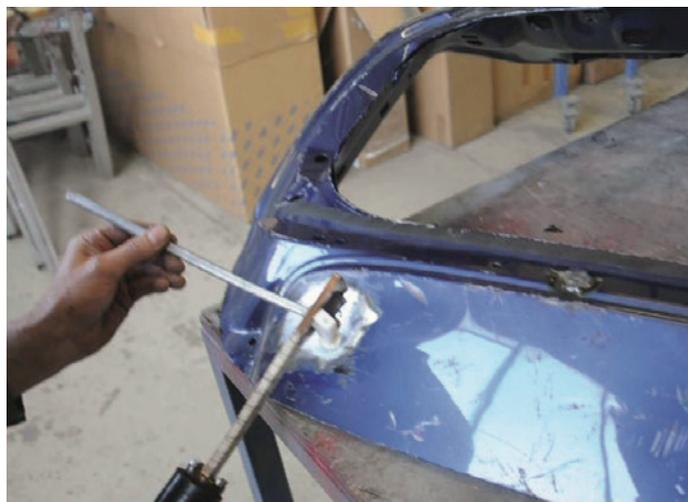
◀ Bild 2. Verzinnen auf Stahl aller Arten und Dicken ist mit Tiefeninduktion einfach und prozesssicher.
