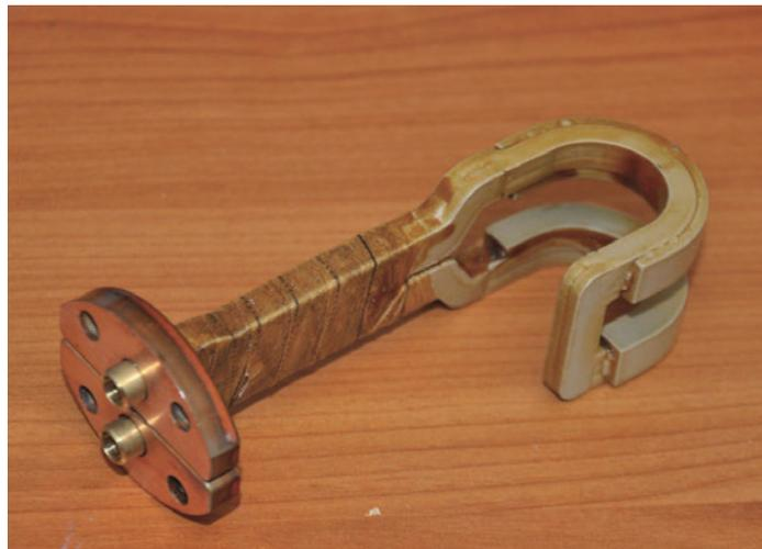
◀ Bild 4. Die offenen Induktorgeometrien der „Hookyduktor“-Serie erlauben das Löten von Rohrverbindungen, bei denen ein Kreislauf geschlossen wird, sodass ein einfacher Ringinduktor nicht mehr herauskäme.
