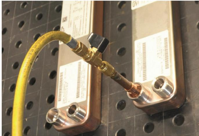
◀ Bild 8. Das Formiergas wird über einen Kugelhahn in passende Fittings gegenüber der geplanten Lötstelle geleitet. Besondere Dichtigkeit ist nach dem Kugelhahn nicht erforderlich.
