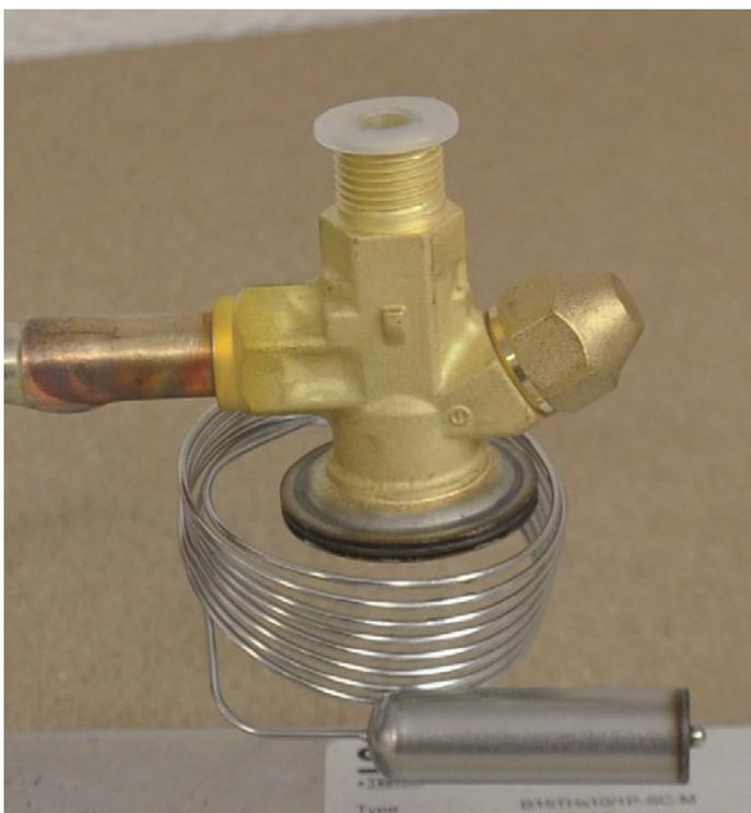
◀ Bild 11. Das zu verlötende thermostatische Expansionsventil: links die Lötstelle, unten die Fühlerpatrone an ihrer Kapillare, oben der Stutzen, in den die Ventildüse eingeschraubt wird
