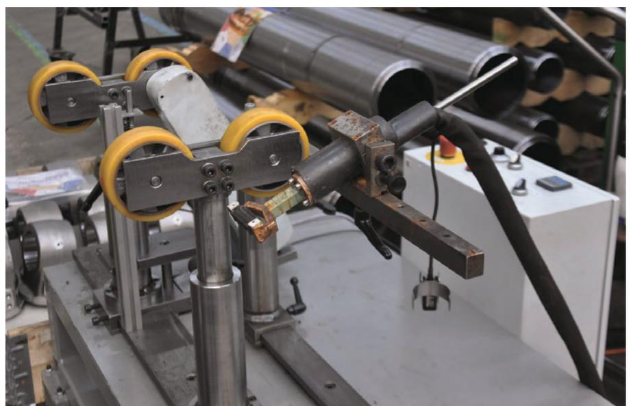
▲ Bild 8. Die verwendete, selbst gebaute Vorrichtung besteht aus einem verstellbaren, angetriebenen Rollenbock und einer Steuerung, mit der die Drehzahl vorgegeben und das Induktionsgerät angesteuert werden kann.
