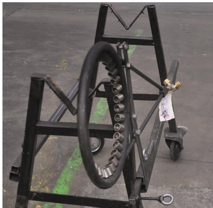
◀ Bild 5. Mit so einem Ringbrenner, betrieben mit Acetylen und Sauerstoff, wurden die Rohrenden bei Hengstler in der Vergangenheit erwärmt.
