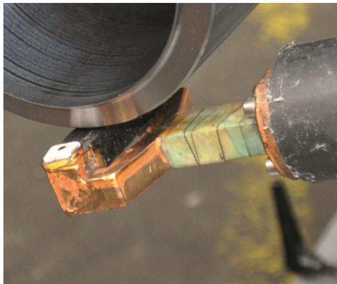
◀ Bild 7. Induktor des Tiefeninduktionsgeräts
