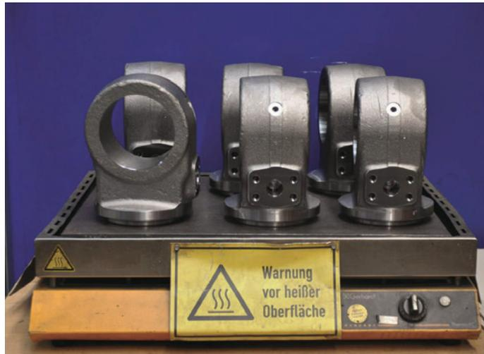
◀ Bild 6. Langsam und energieaufwendig, aber auch mit so einer Herdplatte ist das Vorwärmen der Zylinderböden möglich.
