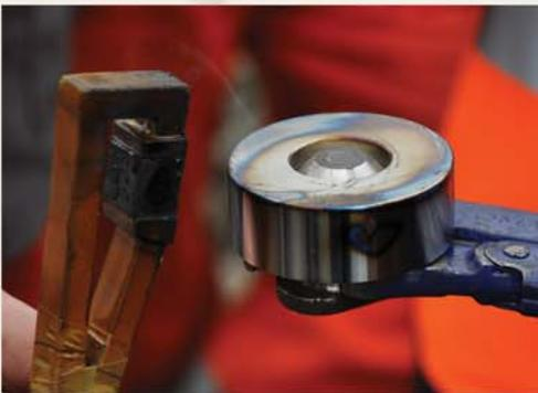
Anwendung: Demontage (und Montage) von Presspassungen. Blitzschnelle Temperaturunterschiede und die Vermeidung von Glühtemperaturen (alles, was glüht, schrumpft!) erlaubt schnellste und vor allem einfach zu reproduzierende Prozesse.
