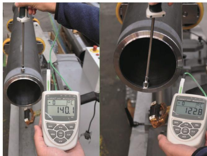
◀ Bild 11. Temperaturmessung jeweils sofort zum Ende eines Wärmeprozesses mit einem Anlegefühler, einmal außen und einmal innen am Rohr
