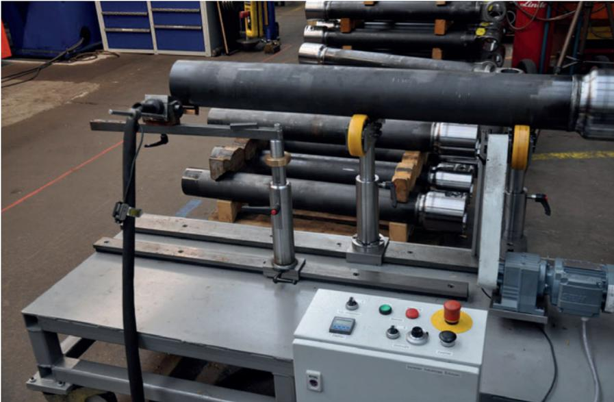
▲ Bild 9. Der Vorwärmstand aus der Bedienerperspektive; gut zu erkennen sind die Verstellmöglichkeiten, die eine Vorwärmung von Rohrgeometrien verschiedener Durchmesser und Längen ermöglichen.
