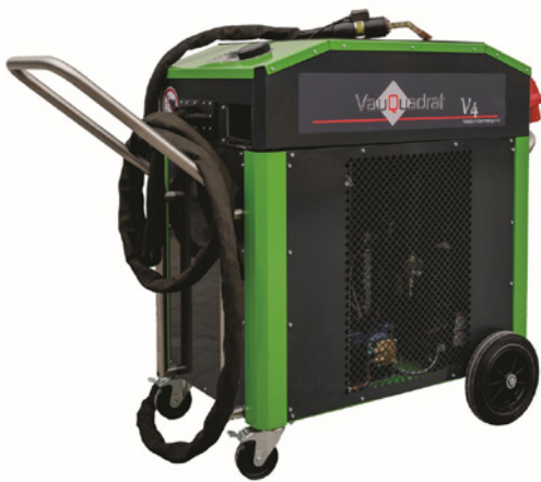
▲ Bild 15. Die hier beschriebenen Richtarbeiten wurden mit dem Tiefeninduktionsgerät „VauQuadrat V4“ der Firma Universal Stahl mit bis zu 18 kW Induktionsleistung ausgeführt (Stromanschluss: 3 × 400 V/32 A inklusive Wasserkühlung). (Bilder: Zipitas (14), VauQuadrat GmbH)
