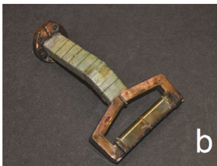
▲ Bild 2. Die Evolution der Feldverstärkerlänge und damit des Richteffekts an dicken Blechen: die „Robbiduktor“-Serie mit 45 mm (a), 60 mm (b) und 120 mm (c) langem Feldverstärker
