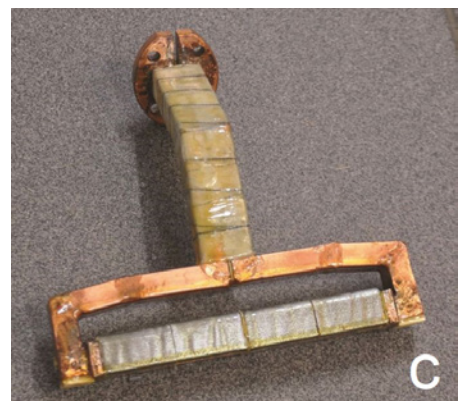
▲ Bild 2. Die Evolution der Feldverstärkerlänge und damit des Richteffekts an dicken Blechen: die „Robbiduktor“-Serie mit 45 mm (a), 60 mm (b) und 120 mm (c) langem Feldverstärker
