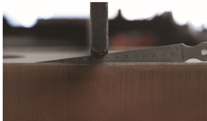
◀ Bild 5. Verzugsmessung vor dem Richtvorgang: 8,2 mm zwischen dem Richtscheit und dem Werkstück
