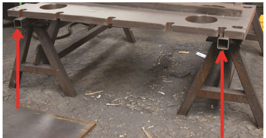
▲ Bild 6. Das Werkstück wird so weit außen gelagert, wie das noch sicher möglich ist. Die durch das Eigengewicht entstehenden Druckspannungen an der Oberfläche helfen.
