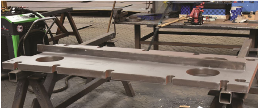
▲ Bild 3. Nach dem Zuschnitt aus einem 60 mm dicken Blech die unschöne Überraschung: links fast 9 mm Verzug
