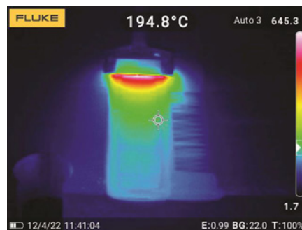
▲ Bild 9. Die Thermografie zeigt, warum das Verfahren so viel Eigendehnhinderung hat: Der größte Teil der Richtnaht ist jeweils noch oder schon wieder bei einer Temperatur, bei der eine relativ hohe Festigkeit vorliegt.
