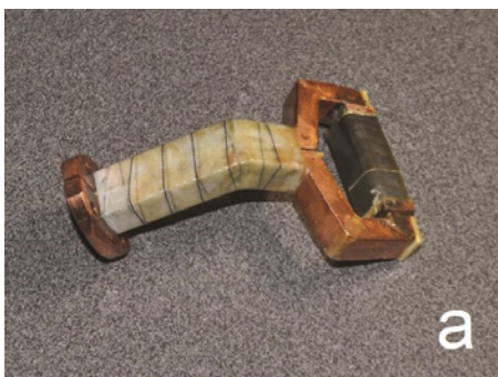
▲ Bild 2. Die Evolution der Feldverstärkerlänge und damit des Richteffekts an dicken Blechen: die „Robbiduktor“-Serie mit 45 mm (a), 60 mm (b) und 120 mm (c) langem Feldverstärker
