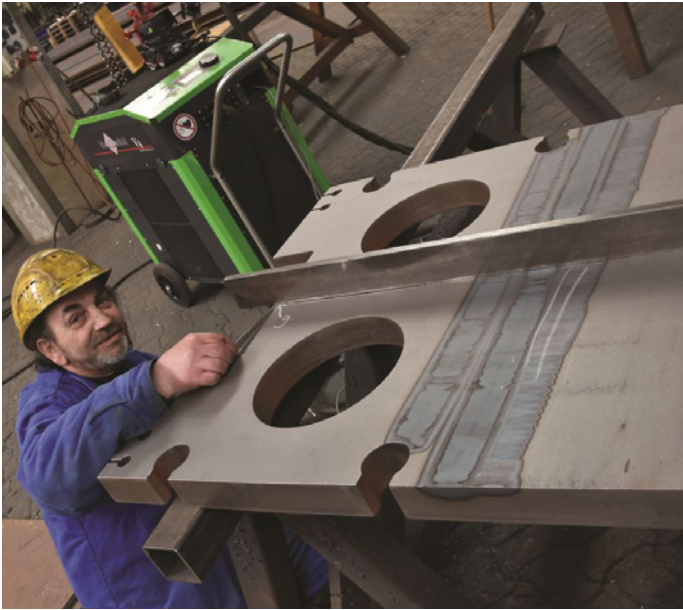
◀ Bild 13. Zwei Richtstriche mit dem Traktor und der manuelle Strich, den man sich hätte sparen können: Graff ist zufrieden mit dem Ergebnis.
