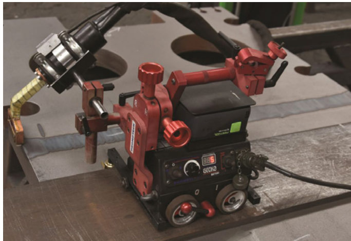
◀ Bild 10. Handelsüblicher Akku-Magnet-Schweißtraktor mit passender Aufnahmevorrichtung für das Induktorgriffstück, einem Ansteuerkabel für das Tiefeninduktionsgerät und Führungsschienen für einen geraden Richtstrich
