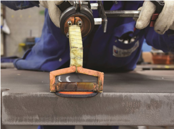
◀ Bild 7. Als Vergleichsreferenz zieht Andreas Graff von Hand einen Richtstreifen quer über das Bauteil...
