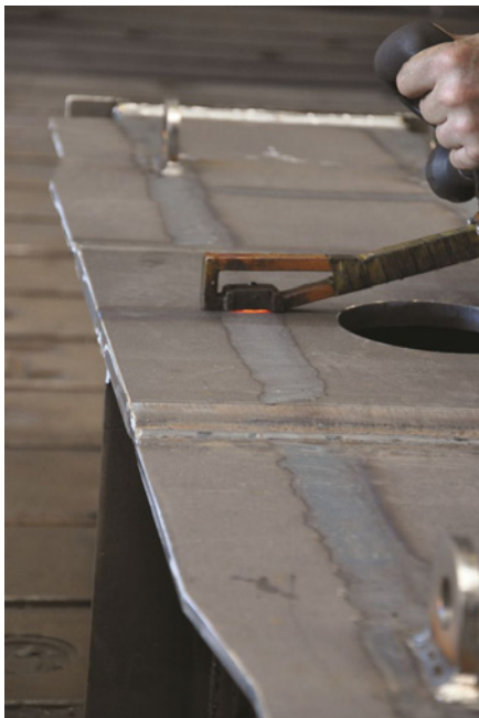
▲ Bild 1. So hat alles angefangen: Richten mit einem Induktor mit 30 mm Feldverstärkerlänge.
