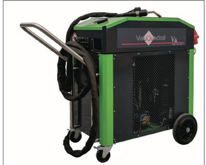
▲ Bild 3. Die hier beschriebene direkt vorlaufende Vorwärmung wurde mit dem Tiefeninduktionsgerät „VauQuadrat V4“ mit bis zu 18 kW Induktionsleistung der Firma Vorndran ausgeführt (Stromanschluss: 3 × 400 V/32 A inklusive Wasserkühlung).
