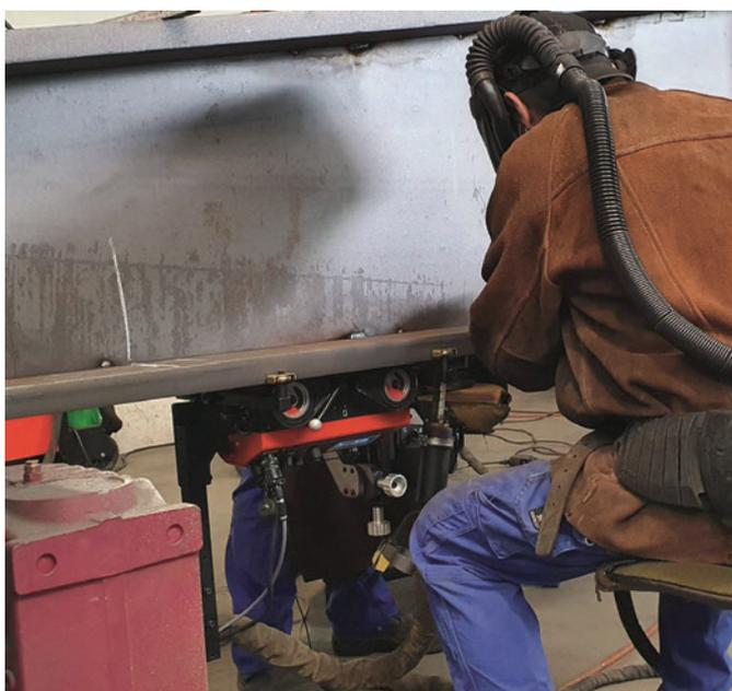
▲ Bild 9. Der Gesamtaufbau: Unten und etwa 15 cm der ersten Schweißposition vorlaufend befindet sich der Magnettraktor mit dem 60-mm-Induktor des Tiefeninduktionsgeräts. Ebenfalls gut zu sehen sind die zwei Führungsstangen des Traktors, mit denen dieser um die Kante des Untergurts greift und damit die Richtung hält.
