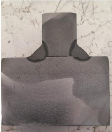
▲ Bild 11. So sieht die fertige Doppelnaht im Schliffbild der Arbeitsprobe aus.
