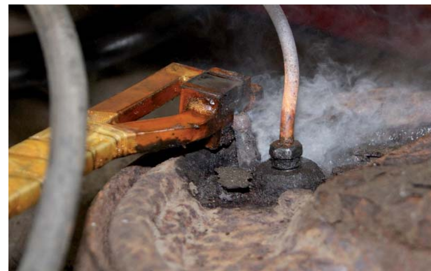
Mit reduzierter Leistung können mit dem Alesco A800 auch Bremsen-Entlüftungsventile aus Aluminium erhitzt werden
