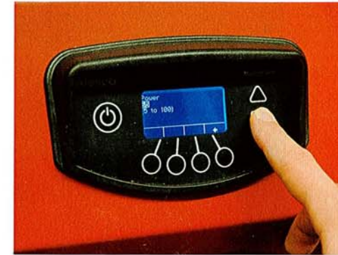
Zu den wenigen erforderlichen Bedienschritten für das Alesco A800 zählt die Eingabe der Leistung in Stufen
