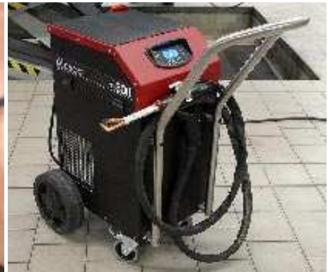
Das Alesco A800 liefert 8 kW Leistung und lässt sich sehr leicht in der Werkstatt manövrieren.
