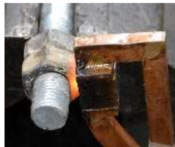
Wärme, die von innen kommt: Beim Erwärmen einer Schraubverbindung mit dem Induktionsheizer bleiben die Randpartien quasi kalt.
