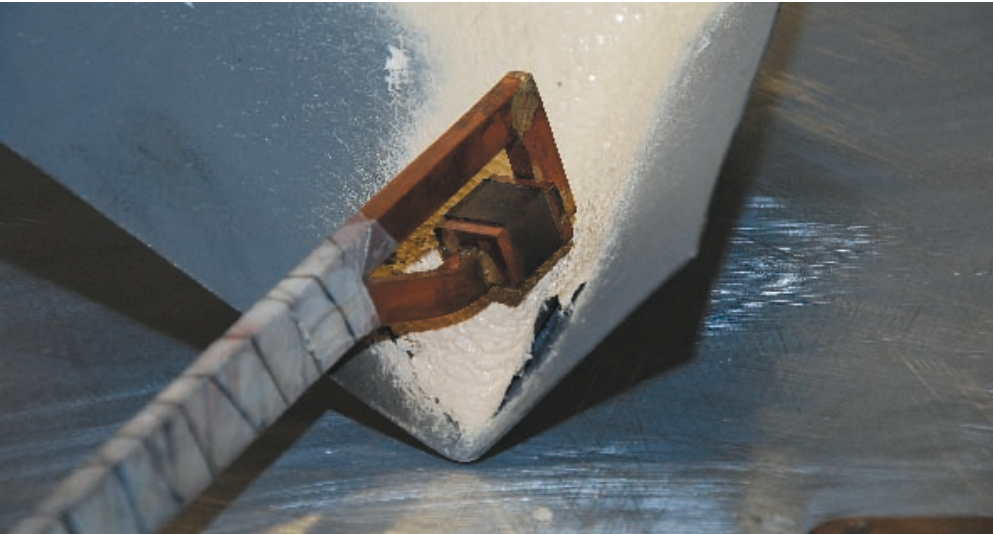
▲ Nachdem der Anwender das Trägerblech kurz mit dem Induktionsheizgerät erwärmt hat, löst sich der Unterbodenschutz von selbst ab.
