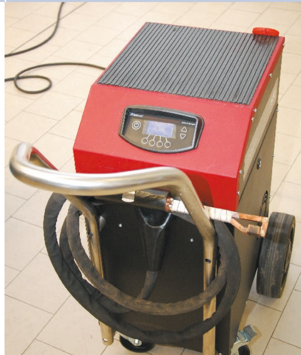
▲ Das Induktionsheizgerät Alesco A800 hat acht Kilowatt.
