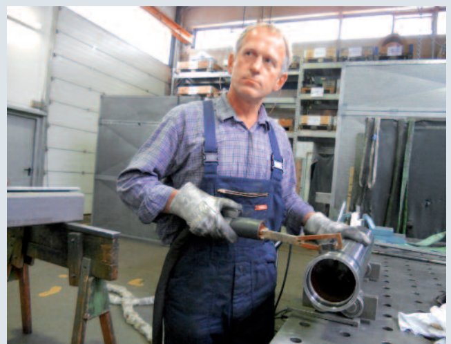
▲ Bild 2. Martin Ossege, seit über 30 Jahren bei Obermeyer, ist unter anderem von der geringen Wärmestrahlung beim Einsatz des Induktors überzeugt.
