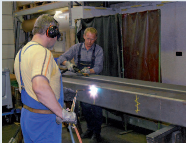
► Bild 3. Induktionsrichten und Flammrichten im Vergleich: Beim Induktionsrichten lässt sich die Wärme „auf den Punkt genau“ einbringen, die Gefahr durch Verbrennungen ist für den Mitarbeiter geringer, und die Abkühlgeschwindigkeit ist höher, wodurch die Durchlaufzeit für ein Werkstück sinkt.
