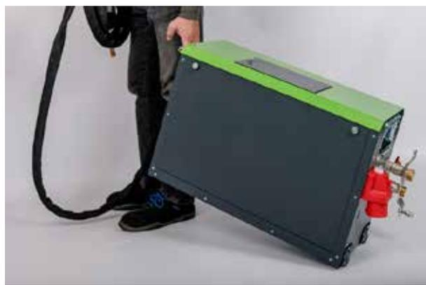
Zusätzlich – nicht im Lieferumfang – wird eine Stromversorgung 3x400V/50Hz 32A benötigt, entweder durch eine übliche CE-Dose oder beispielsweise durch einen ebenfalls auf dem Fahrzeug montierten Stromgenerator.
