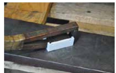
(Art.Nr. 4.NC 106 für den Induktor V4 Standard) geschehen, bei Zieltemperaturen unter 100°C durchaus auch durch einen untergelegten Arbeitshandschuh! Man hat damit gleich eine ideale Temperaturüberwachung: Was auch immer zwischen Induktor und Werkstück für Abstand sorgt, darf nicht anfangen zu rauchen oder gar zu brennen – oder man macht etwas grundlegend falsch.
