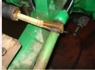
Ausbau eines eingeklebten Kugelkopfes
