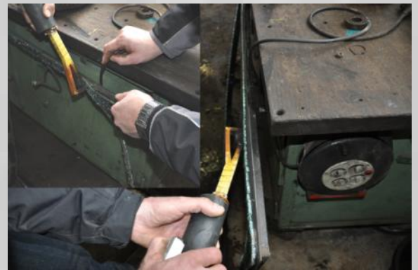
Ablösen von auf Metall geklebten Bauteilen, z.B. Glas, Gummi, Folie, Kunststoff...
