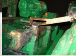
Lösen festsitzender Schraubverbindungen und Bolzen, auch vom Kopf her!
