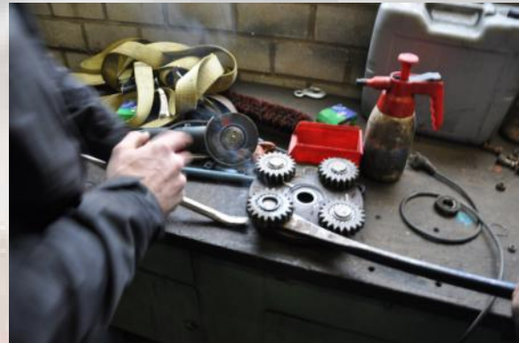
Ausbau gepresster Lager
