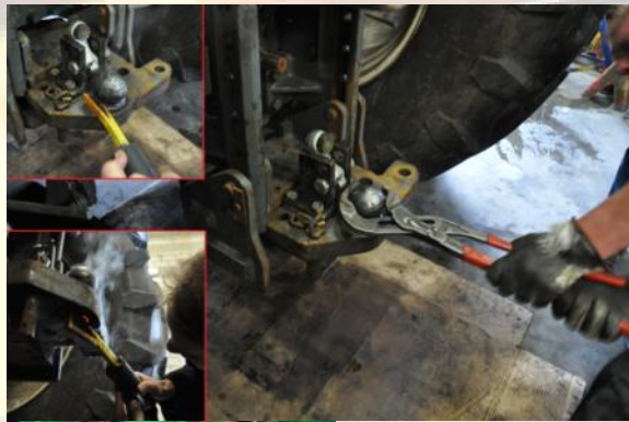
Ausbau eines eingeklebten Kugelkopfes
