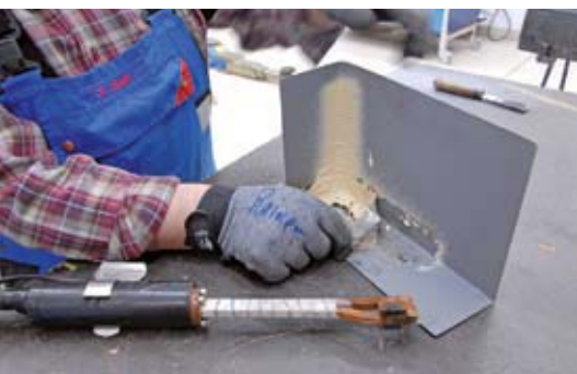
Nach dem Erwärmen lässt sich der Unterbodenschutz mühelos abziehen.
