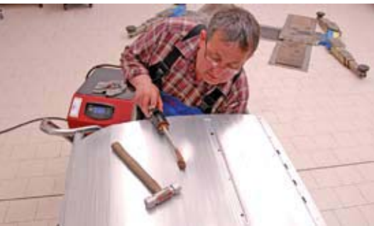
Beim Einziehen und Schrumpfen von Aluminiumblech liefert das Alesco A800 genügend Leistungsreserven.
