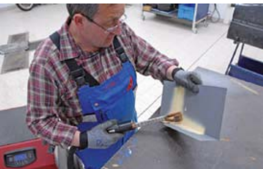
Beim Entfernen von Unterbodenschutz in schlecht zugänglichen Ecken wird das Blech induktiv erwärmt.
